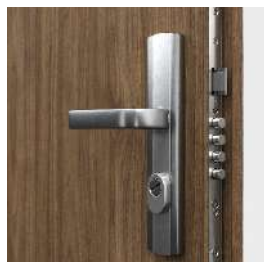
broască tip bandă, multi-punct, pregătită pentru 2 cilindri
